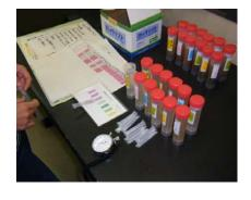
※CODの測定では反応時間(溶液を吸入してから色を判定するまでの時間)は必ず守って下さい。また、直射日光の当たらない15~25℃の室温で行って下さい。
